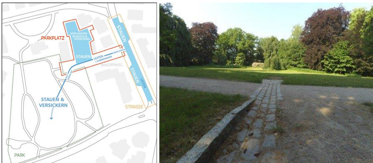
Obr. P17. Povrchové odvodnění odvádějící srážkový odtok z přívalových dešťů k dočasné retenci v Ohlendorffově parku v Hamburku (Schéma OSP 2012, Foto M. Suchan)
